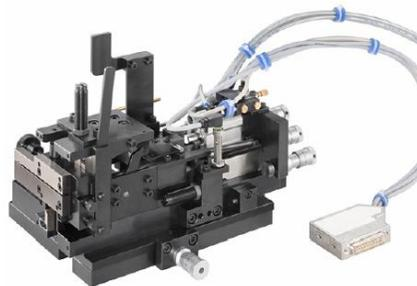
Modul für die Bearbeitung von Leitungen mit kleinem Querschnitt
